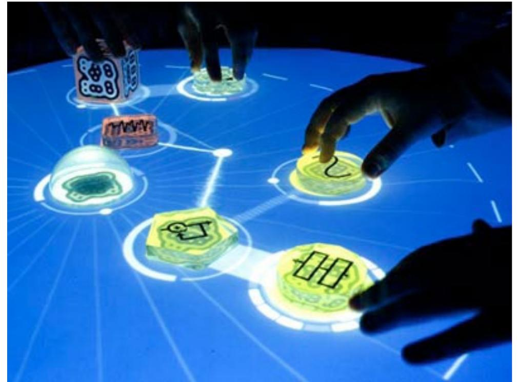
*L'utilisateur peut modifier leurs interactions en augmentant ou en réduisant leur distance, en les pivotant pour varier la fréquence du signal et même jouer avec l'amplitude en déplaçant son doigt autour de l'élément, etc. grâce à ses capacités tactiles.*
