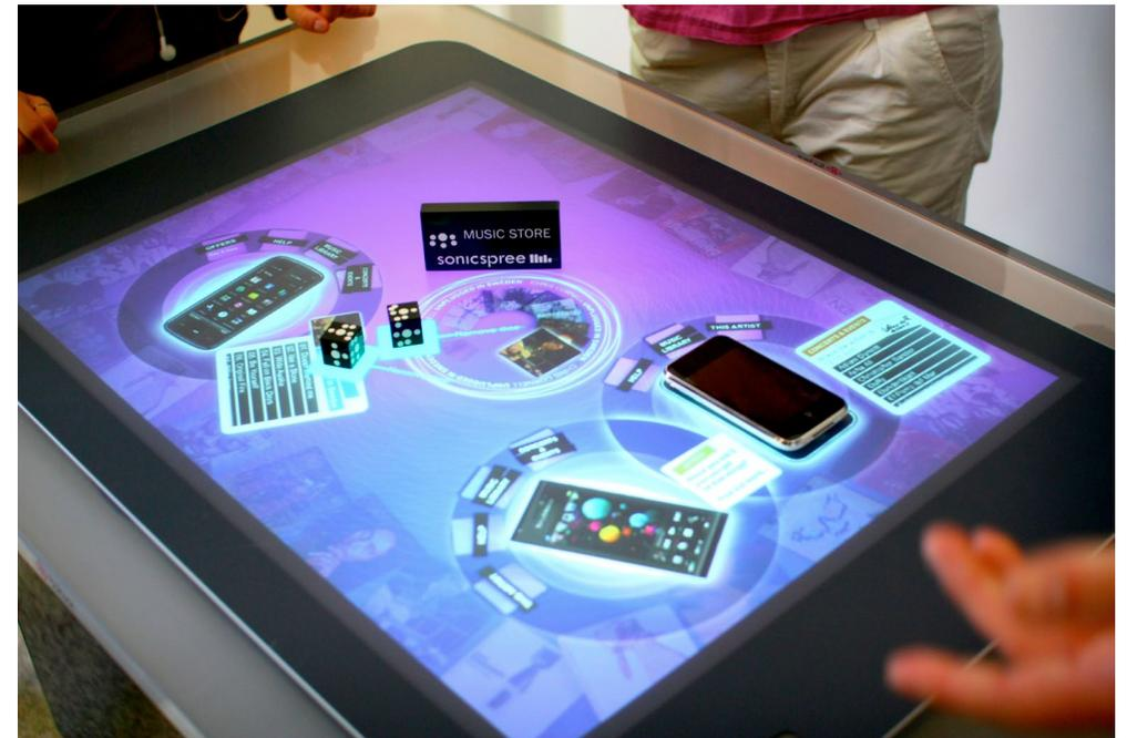
*Lorsqu'un smartphone y est déposé, le téléchargement des photos et/ou vidéos qu'il contient se fait automatiquement et les informations apparaissent en éventail. De même pour interagir avec du contenu virtuel lorsque l'on dépose certains objets munis de code-barres.*
