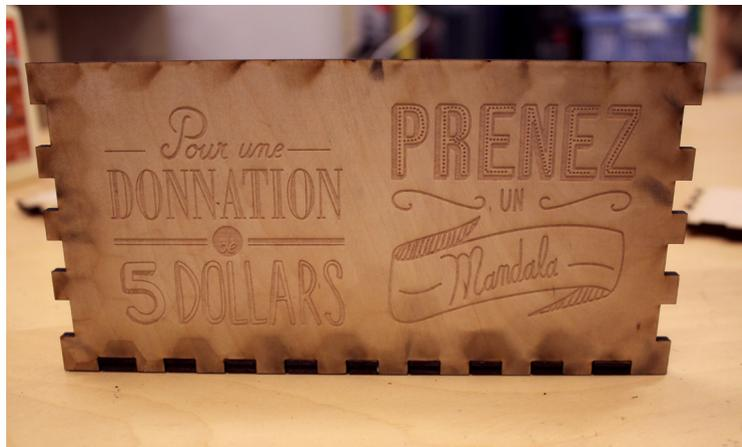
Mes connaissances en matière de découpe laser ont pu être approfondies par une formation dispensée par le représentant de Trotec. J'ai alors réalisé une boîte pour disposer les logos préalablement découpés. Bien qu'il existe des sites permettant d'obtenir immédiatement les dimensions nécessaires pour la réalisation d'une boîte, il m'a fallu faire plusieurs essais pour obtenir les dimensions me permettant d'ajouter un couvercle coulissant.
