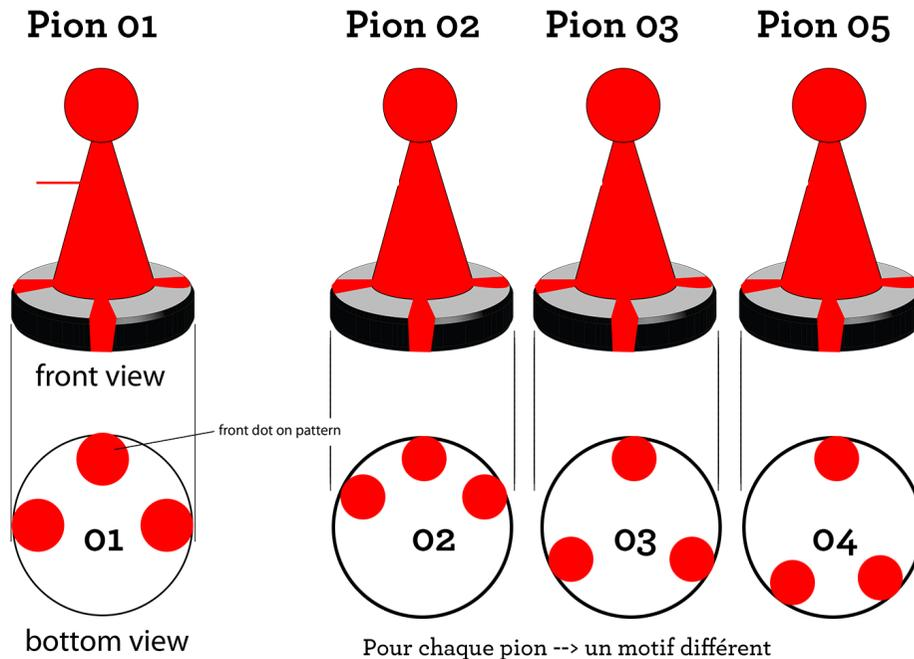
Le pion est reconnu grâce à un motif dessiné sous son socle. Il n'y a aucune électronique, ni puce NFC ou RFID dans les objets. Les pions sont chargés de l'électricité statique de l'utilisateur. Le système peut alors reconnaître la position, la rotation et l'identité de l'objet en temps réel.
