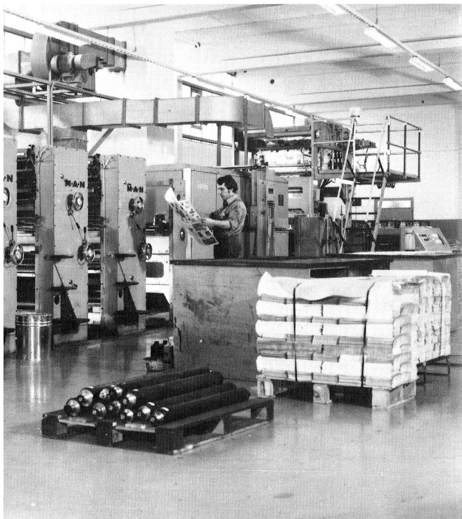
5— Presse rotative offset en production, l'Imprimerie, une Profession, un Art , Robert Mathieu, dunod éditeur, 1979, p.98.
