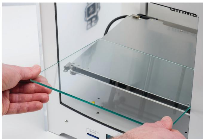
**ATTENTION:** les loquets de la plaque de construction peuvent être aiguisés. Nous vous conseillons donc d'utiliser une clé Allen pour les ouvrir.
